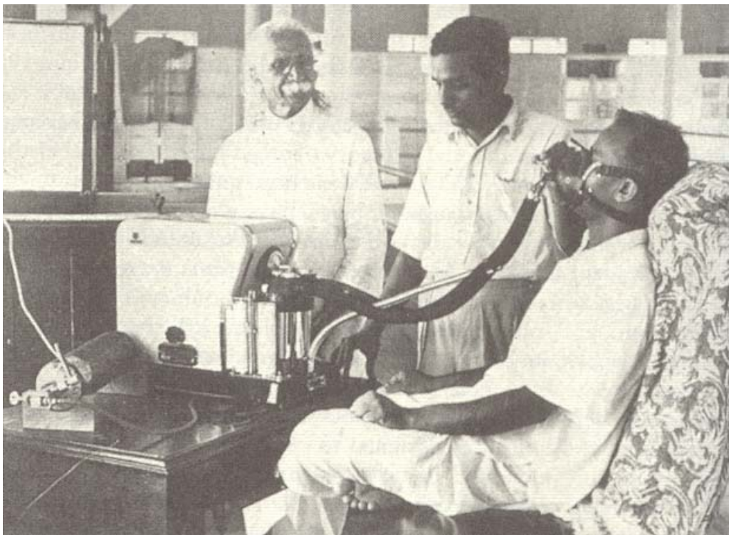
Swami Kavalayananda (mit Schnurrbart) überwacht einen Versuch, bei dem der Sauerstoffverbrauch während einer Yogaübung gemessen wird.
